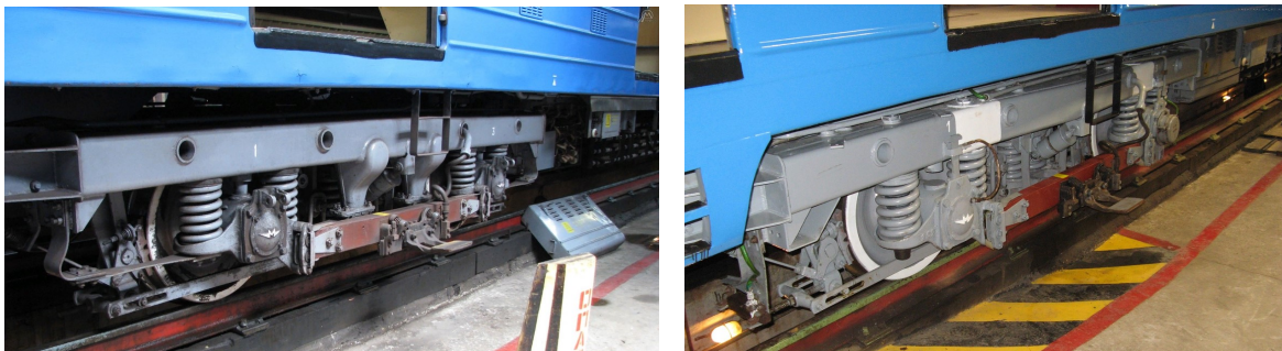
Рис. 1. Візки вагону метрополітену: а – повідцевий, б - шпінтонний
