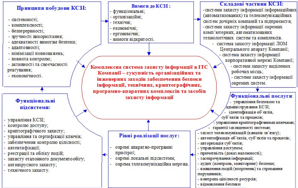
Рисунок 2.7. - Комплексна система захисту інформації (принципи побудови, вимоги, функціональні підсистеми, послуги)
