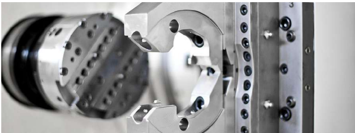
Рисунок 5.47 Загальний вигляд затискного пристрою, встановленого на АВ TRANSFER TRO фірми Porta Solutions
