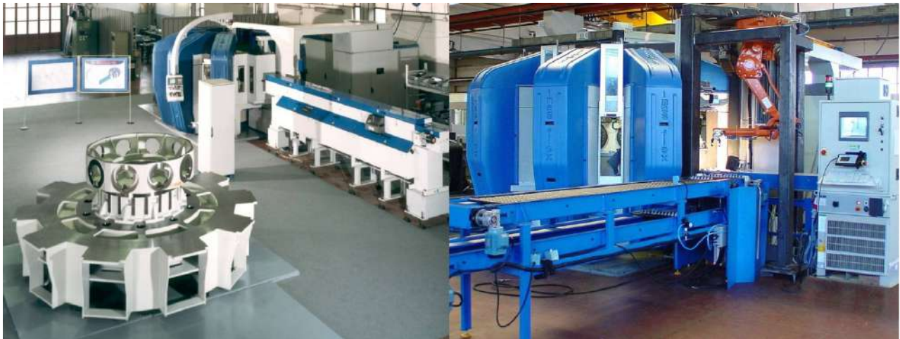
Рисунок 5.33 АВ повністю інтегрований з обладнанням подачі дроту
