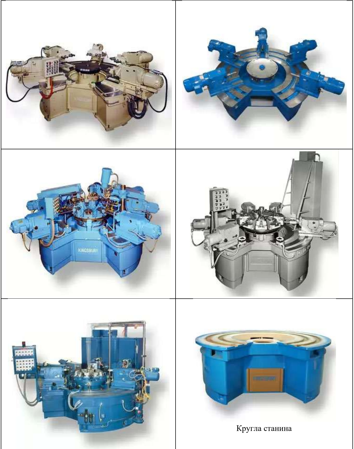
Рисунок 5.7 Багатопозиційні АВ Webco/Kingsbury горизонтального компонування з поворотно-розподільчим столом
