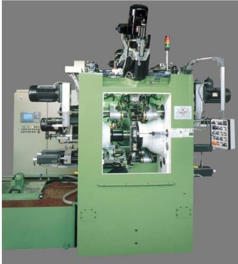
Рисунок 5.43 Компонування а грегатного верстата з поворотно-розподільчим барабаном Picchi TR 6-9/OSE
