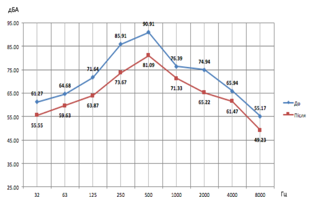
Рис. 4. Графік обчислень в ресторані до включення пристрою та після для білого режиму
