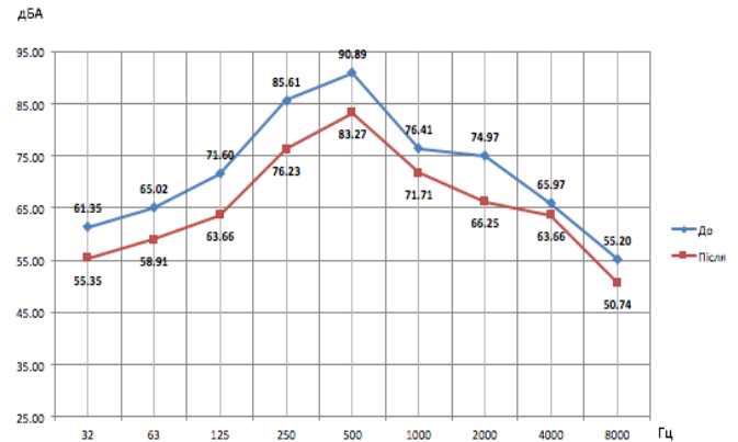
Рис. 8. Графік обчислень в ресторані до включення пристрою та після для синього режиму
