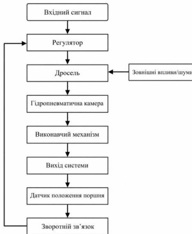
Рисунок 4 – Базова структура слідкувальної ГПС з урахуванням зовнішніх впливів і шумів
