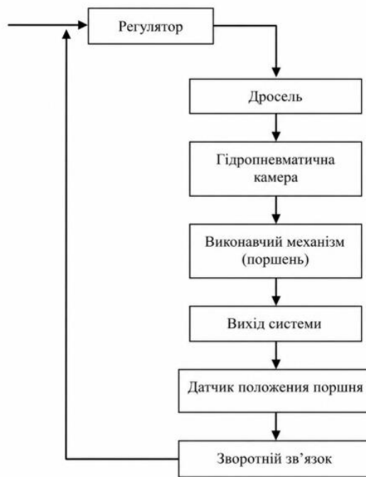
Рисунок 3 – Базова структура слідкувальної ГПС з детальним зворотним зв'язком
