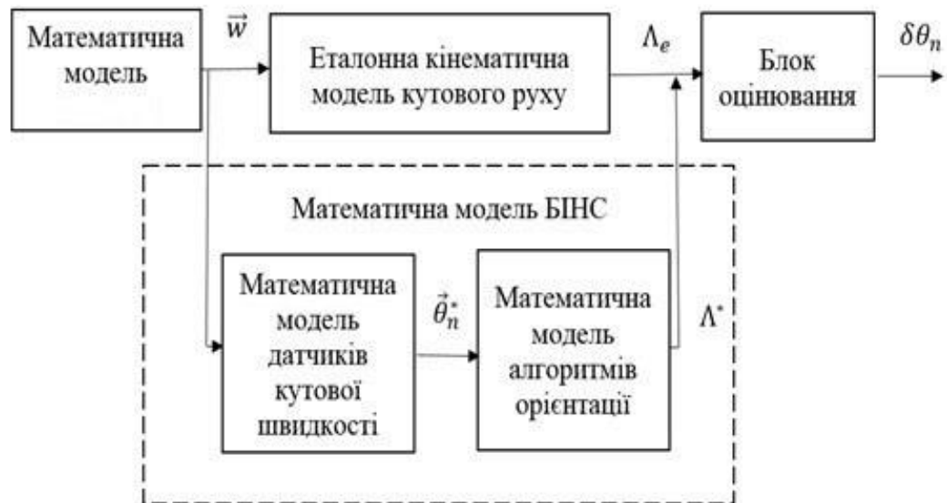
Рисунок 2.2 – Схема тестування алгоритмів на еталонних кватерніонних моделях
