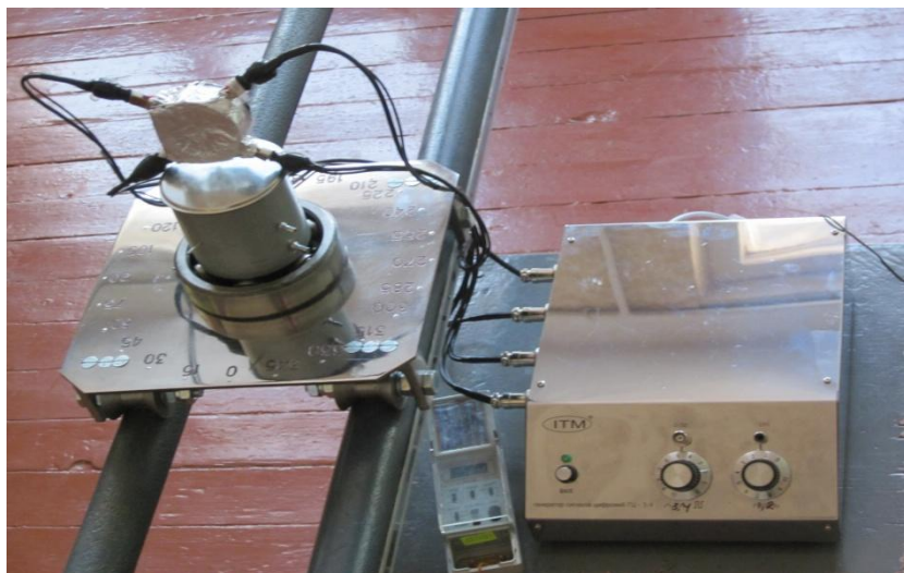
Рис. 1. Чотирьох каналний аналізатор імпульсів з приладом для вимірювання кутів (радіометр ДКС 01 SELVIS застосовується для контролю потужності експозиційної дози \gamma -випромінювання).
