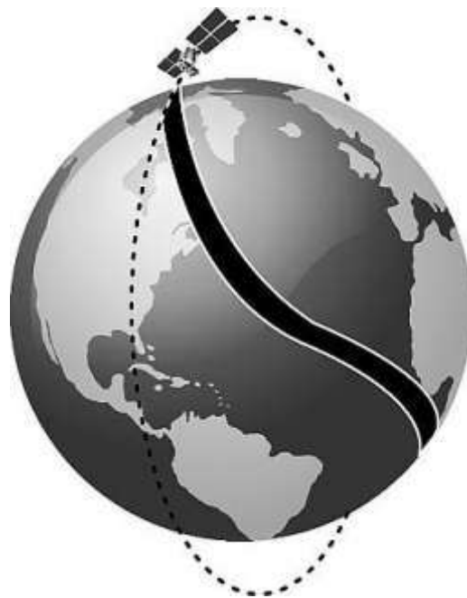
Рис. 3.4 – Зміщення смуги сканування в наслідок обертання Землі
