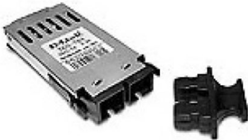
Рис. 2. Модуль GBIC DGS-703 з одним портом 1000Base-LX для одномодового оптичного кабеля.
