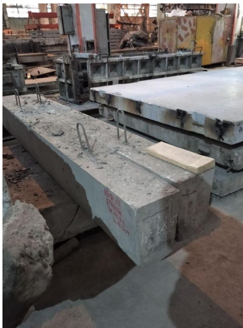
Рис. 1 – Виготовлення експериментальних зразків фундаментних балок на базі ТОВ ЗЗБК «Еталон», м. Харків
