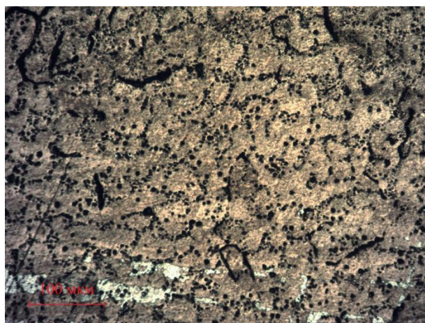
Рис. 2. – Металографічне зображення структури сплаву Fe–W ( W \sim 1,0 ат. %)
