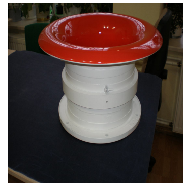
Рис.6 Функциональные изделия из полиамидного порошка «выращенное» на установке Vanguard HS, подготовленное к приемке
