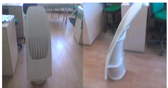
Рис.3 Функциональное изделие «выращенное» на установке Vanguard HS
