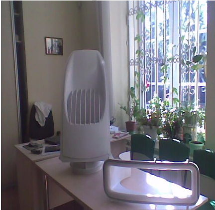
Рис.4 Функциональные изделия из полиамидного порошка «выращенное» на установке Vanguard HS, подготовленное к приемке
