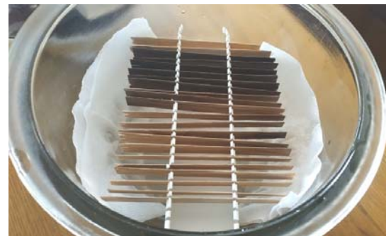
Рис. 2 – Проведення експерименту на водопоглинання
