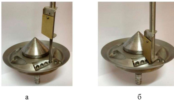
Рис. 1 – Внешний вид устройства для установки экрана перед соплом завихрителя на период, равный 5-ти секундам: а – положение над соплом (вне струи); б – перед соплом (в зоне действия струи)
