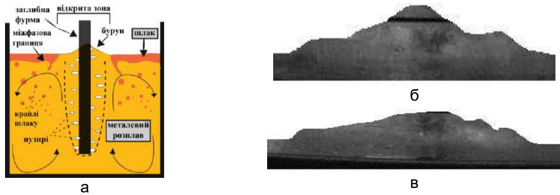
Рис. 1 - Схема формування (а) та профіль буруна (б, в) на поверхні модельної ковшової ванни при швидкості обертання 2-х соплової фурми у 120 об/хв. (б) та 240 об/хв. (в) з витратою газу 2,2 л/хв. та 1,0 л/хв. відповідно
