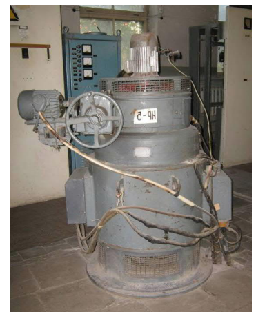
Рисунок 6.10 – Електрична схема експериментальної лабораторної установки для дослідження комплексного впливу ЛЕП+ТП за МП (а) та індукційний регулятор типу IP-59/32 (б) для живлення макету ЛЕП
