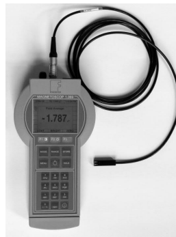
Рисунок 6.11 – Магнітометр типу Magnetoscor 1.069 для вимірювання діючого значення індукції МП промислової частоти
