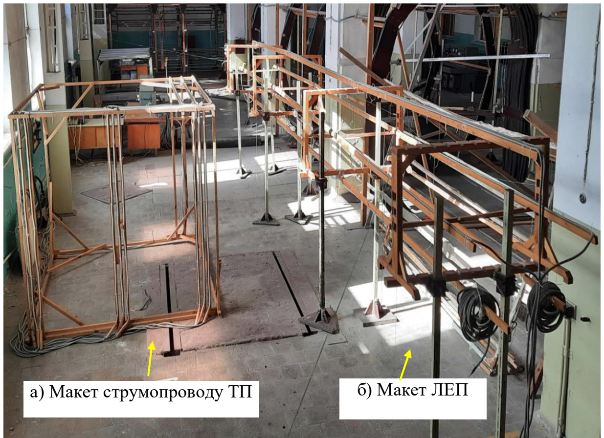
Рисунок 6.8 – Експериментальна лабораторна установка для дослідження комплексного впливу за МП ЛЕП та ТП (а – макет трифазного низьковольтного струмопроводу ТП 100 кВА; б – макет трифазної ЛЕП)
