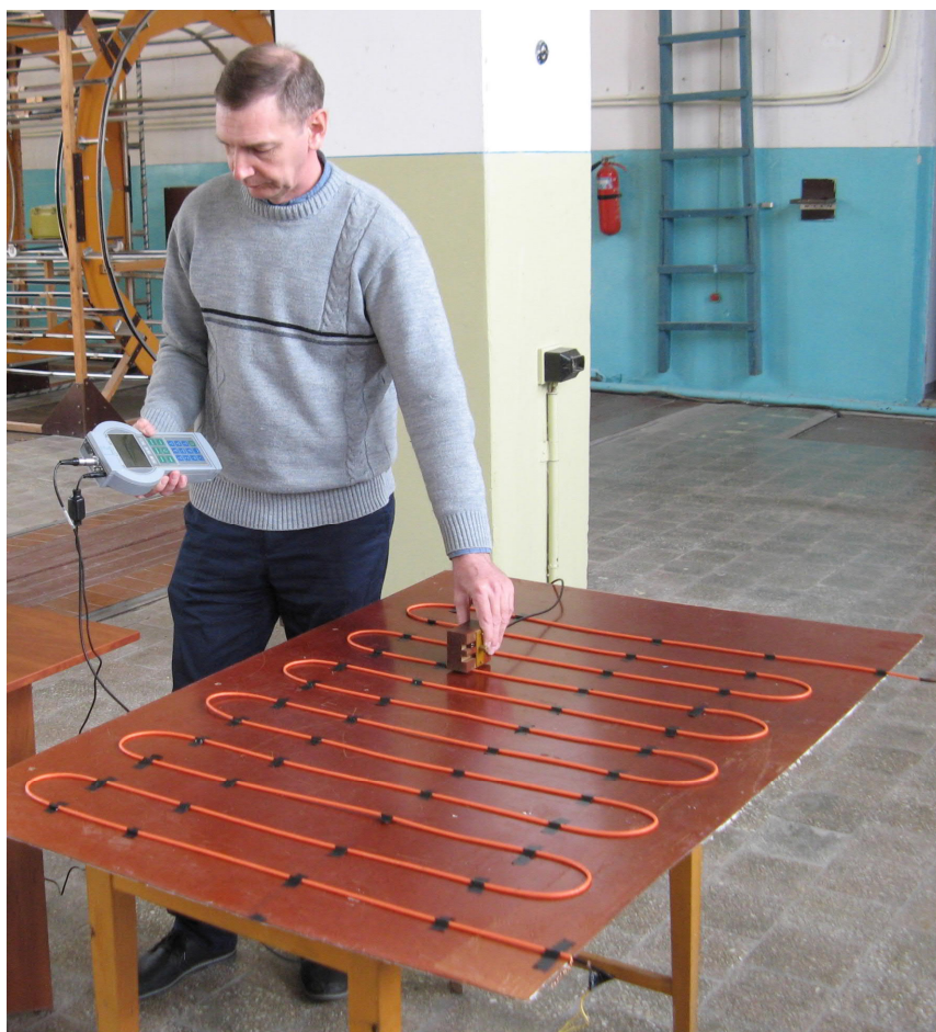
Рисунок 5.15 – Дослідження розподілу індукції МП лабораторного макету СКЕ з коаксіальним НК типу «VOLTERM» на магнітовимірному стенді ІЕМС НАН України
