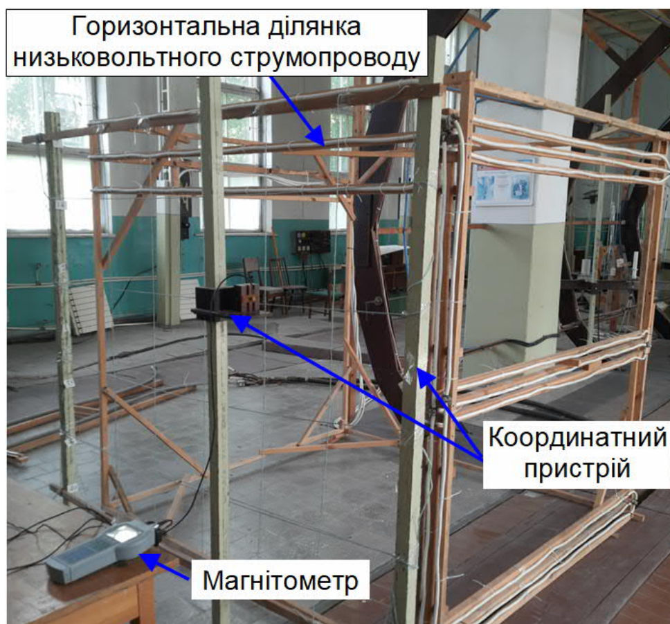
Рисунок 4.11 – Лабораторний макет струмопроводу низької напруги ТП 10/0,4 кВ, 100 кВА на магнітовимірювальному стенді ІЕМС НАН України
