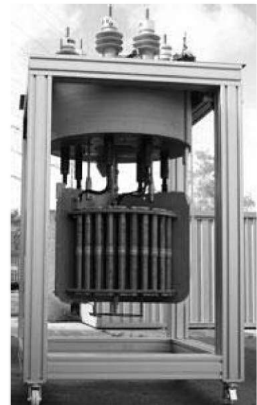
Рисунок 5.44 – Прототип ВТНПОС CULT-110 (Nexans / ASL)
