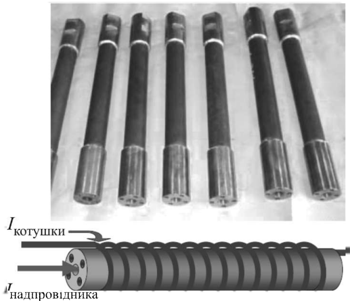
Рисунок 5.38 – Елементи для попереднього прототипу ВТНПОС Matrix
