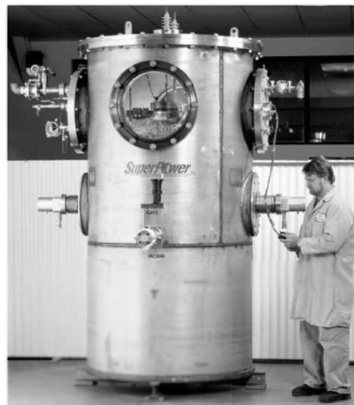
Рисунок 5.36 – Однофазний попередній прототип Matrix у криостаті
