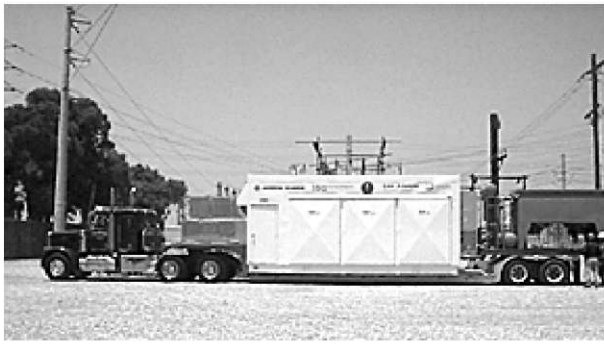
Рисунок 5.50 – ВТНПОС випрямного типу потужністю 20 МВА: a – ВТНПОС, розміщений на трейлері (1999 р.); б – ВТНПОС в енергосистемі Каліфорнії у м. Норфолк (2000 р.)
