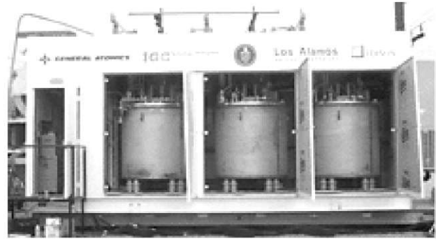
Рисунок 5.50 – ВТНПОС випрямного типу потужністю 20 МВА: a – ВТНПОС, розміщений на трейлері (1999 р.); б – ВТНПОС в енергосистемі Каліфорнії у м. Норфолк (2000 р.)
