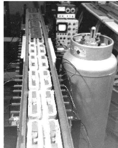
Рисунок 5.9 – ВТНПОС „ Cryo-Pinch ” (4160 В), виготовлений за патентом США 5642249
