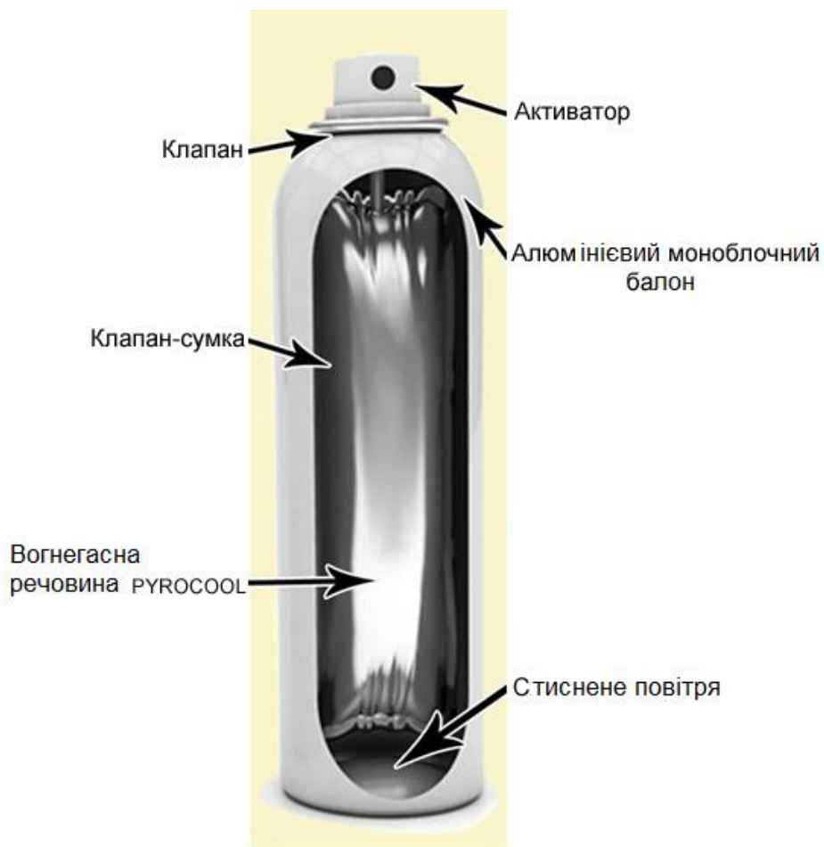
Рисунок 14 – Будова вогнегасника водопінного аерозольного Pyrocool ВВПА
