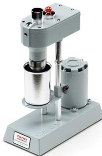
Рис. 2. - Віскозиметр типу Fann 35, комплектується ротором, балансиrom, торсіонною пружиною
