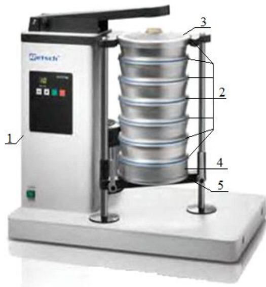
Рисунок. 1.1– Лабораторний вібростенд з пристроєм для установки набору сит: 1 – вібростенд; 2 – сита; 3 – кришка; 4 – піддон; 5 – пристрій для установки сит
