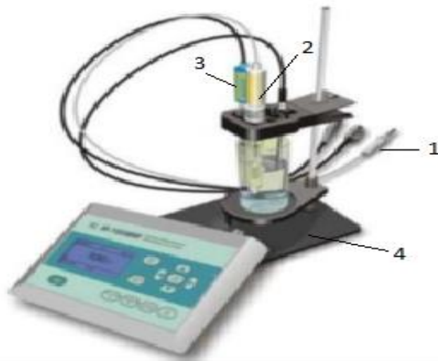
Рис. 1.1. - рН-іономір И-160 МИ 1- термодатчик; 2- рН-електрод; 3-електрод порівнювання; 4-штатив
