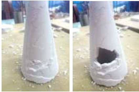
Рисунок 1. Обтічник з дефектами
