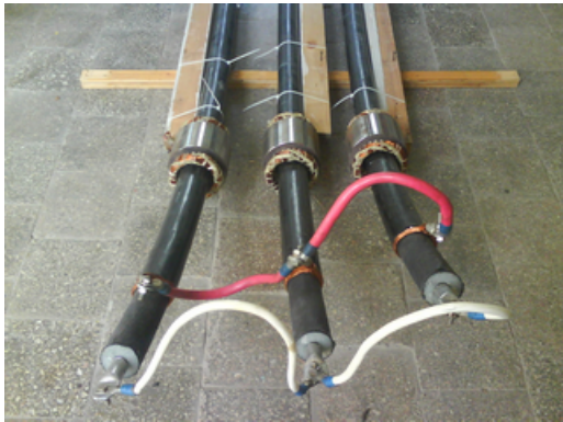
Рисунок 10 – Макет трифазної КЛ, кабелі якої охоплені ФО
