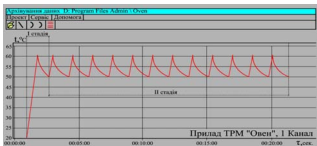
Рис. 4 – Визуальное отображение процесса работы ИК-нагревателя ПЛЭН в циклическом режиме с помощью программы ТРМ «Oven»
