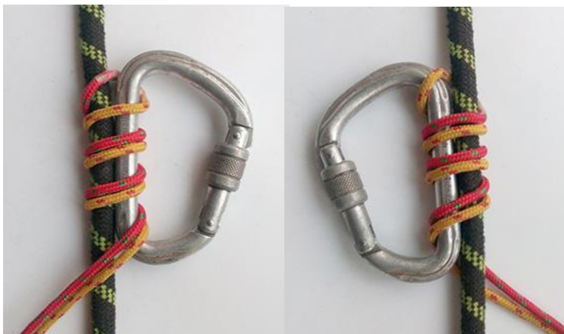
Рисунок 2.5.3 - Повинно бути не менше 3-х обертів петлею допоміжної
