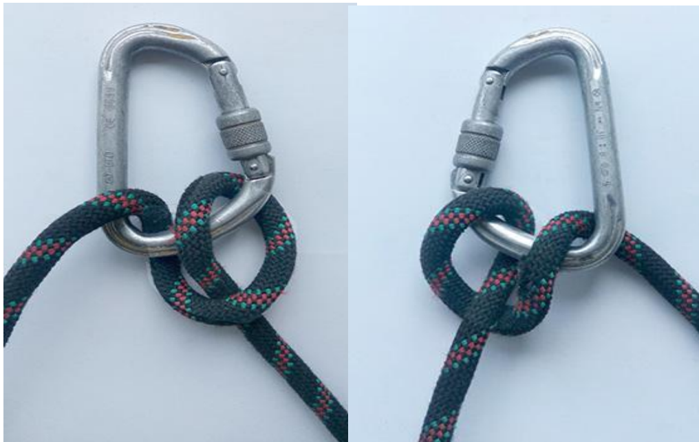
Рисунок 2.6.1 - Використовується як гальмівний пристрій для страховки або спуску по вертикальних перилах (спуску потерпілого).
