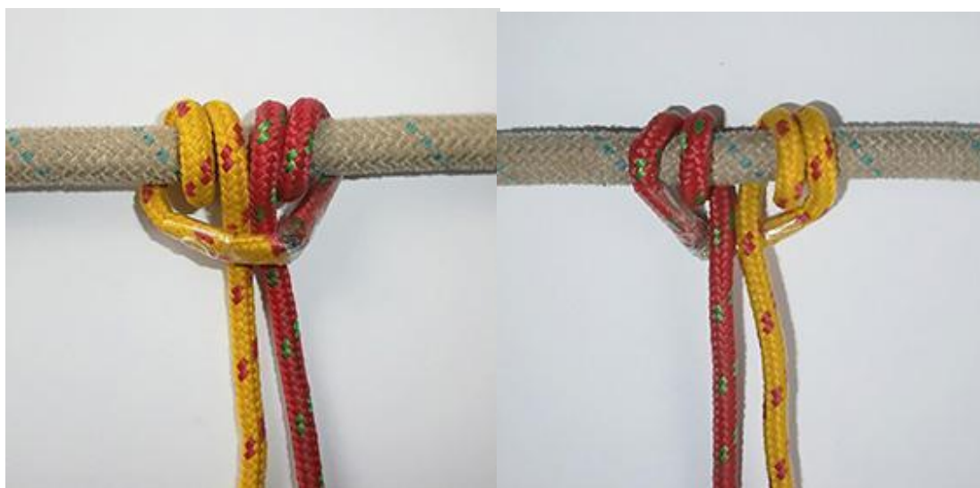
Рисунок 2.2.5.1 - Повинно бути два оберти петлею допоміжної мотузки навколо основної. Може в'язатись одним кінцем.
