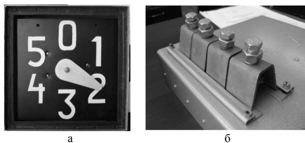
Рис. 1 – Фіксатор короткого замкнення: а – циферблат; б – зовнішня частина магнітної системи
