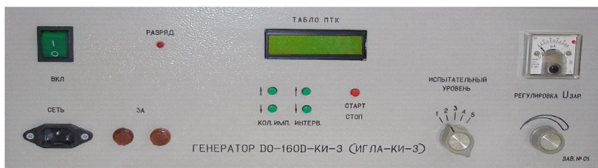
Рисунок 3 – Передняя панель генератора ИГЛА-КИ-3
