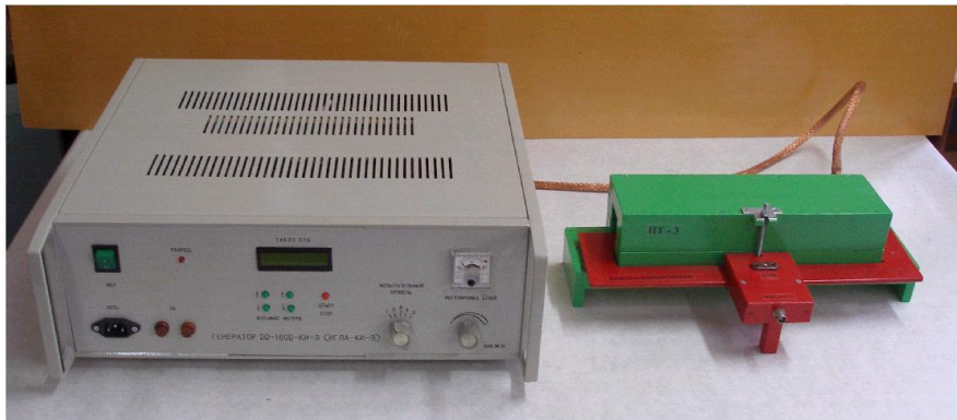
Рисунок 2 – Общий вид генератора ИГЛА-КИ-3 с ИТ-3
