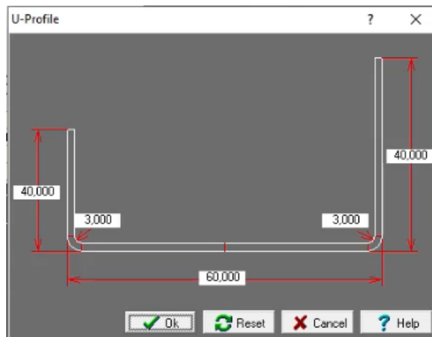
Рисунок 8.2 – Задання параметрів перерізу профілю
