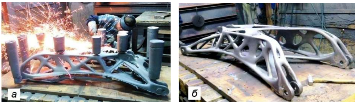
Рис. 2. Каркасний виливоч: а - при обробці; б – після видалення заливів і надливів.
