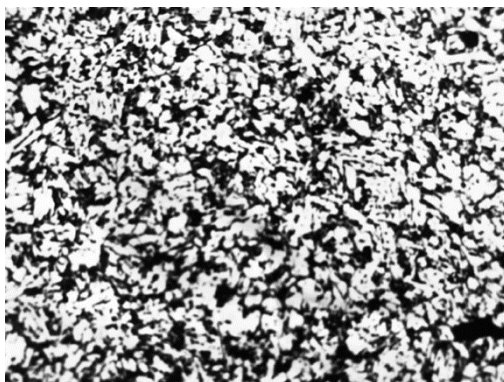
Рис. 12. Структура ділянки неповної перекристалізації ЗТВ зварного з'єднання паропроводу гострої пари зі криці 15X1M1Φ. Напрацювання 276000 годин, \times 160 .
