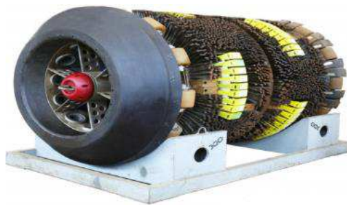
Рис.3. Ультразвуковий дефектоскоп ДЭМАБ-1400 для контролю труб великого діаметру при діагностиці з внутрішньої сторони. Надійно виявляє стрес-корозійні пошкодження [3]
