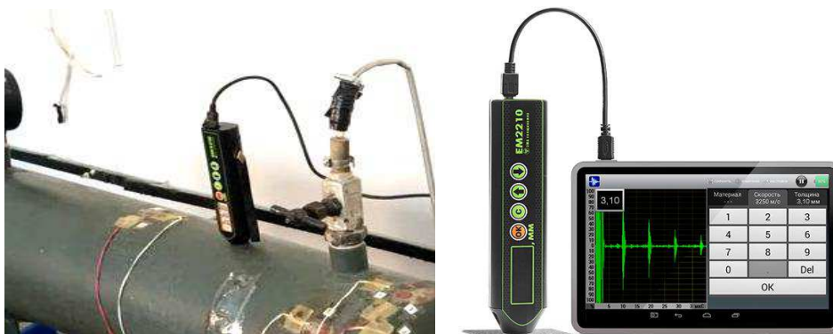
Рис.1. Електромагнітно – акустичний товщиномір фірми Октанта з діапазоном вимірювань товщини стінки труби 2...6 мм через діелектричні покриття товщиною до 3 мм. Похибка вимірювань товщини 0,08 мм [2]
