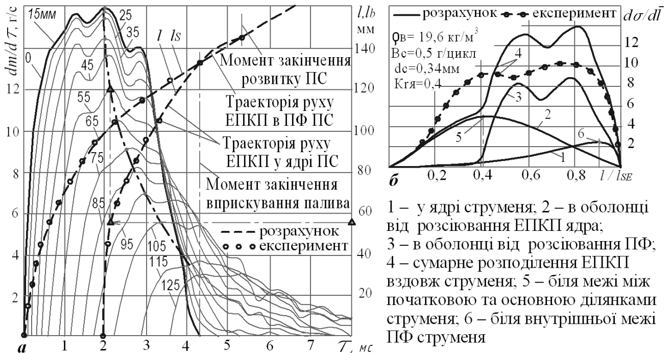
Рис.2. Характеристики руху і розподілу палива в ПС при імітації умов паливоподачі в дизелі 12ДН23/30: а – миттєві витрати палива через контрольні перетини струменя на відстані від форсунки 0 -125мм; б - розподіл палива по довжині ПС на момент закінчення його розвитку; l_s - довжина струменя; l - характеристика руху ЕПКП, поданої з максимальною швидкістю
