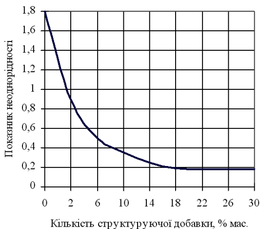
Рис. 3 – Залежність показника неоднорідності ВМК від кількості вуглецевих структуруючих добавок (гідролізний лігнін)
