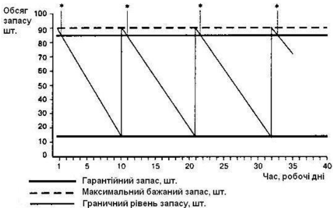
Рисунок 4.1 – Графічна модель роботи системи управління запасами з фіксованим розміром замовлення без збоїв у постачаннях
