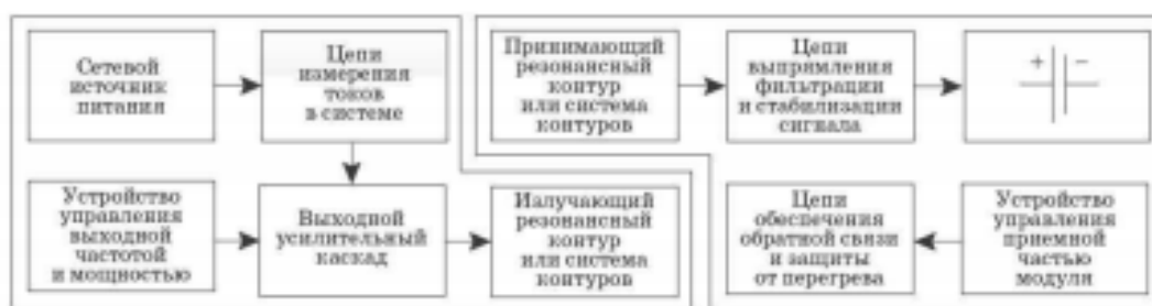
Рисунок 1 – Структурная схема приемопередающих частей БИМП
