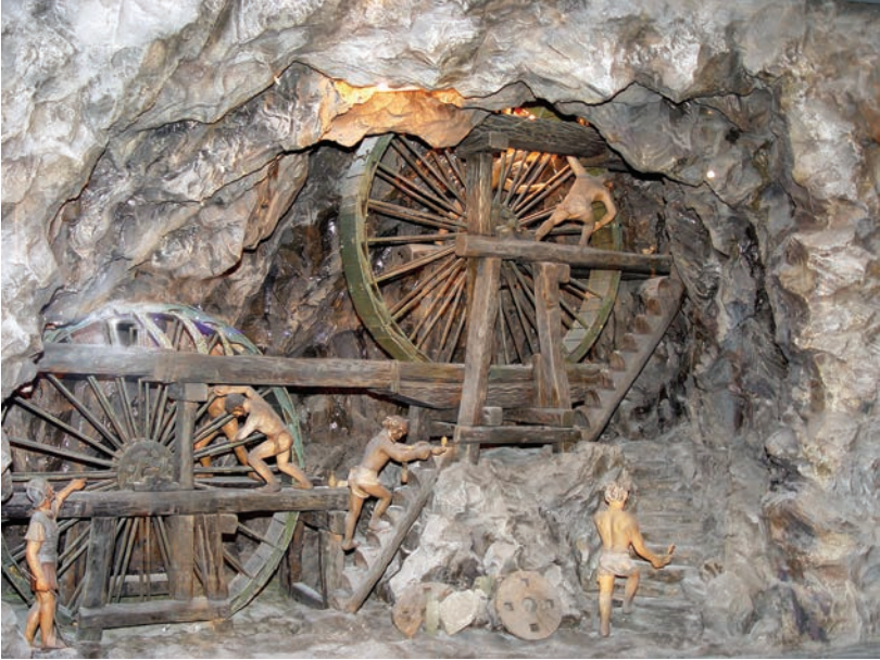
Праця рабів на водовідливних колесах у рудниках давньоримської доби (модель-реконструкція). Німецький гірничий музей у Бохумі
