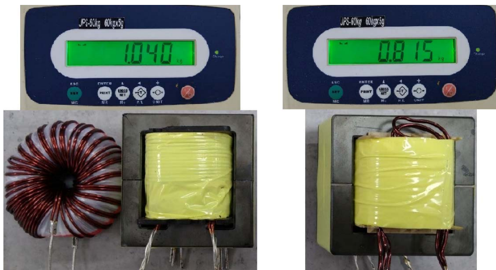
Рисунок 4.8 – Використовувані магнітні елементи для однієї фази комутації: а - для Half-Bridge-3ph перетворювача, б – для перетворювача з CME
