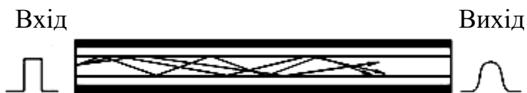
Рисунок 4.6 – Поширення світла в багатомодовому кабелі
