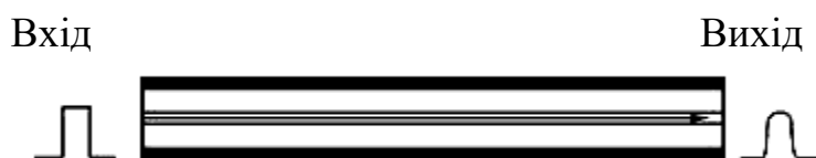
Рисунок 4.5 – Поширення світла в одномодовому кабелі
