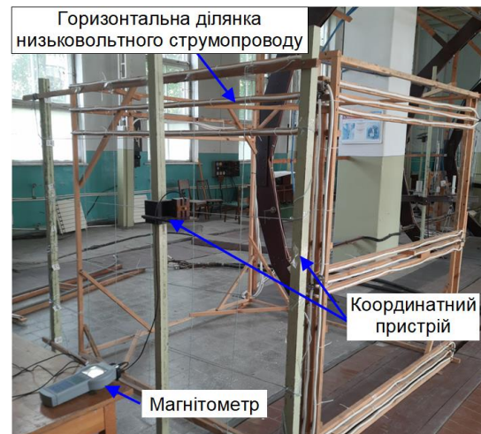
Рис. 2. Лабораторний макет струмопроводу низької напруги ТП 10/0,4 кВ, 100 кВА на магнітовимірювальному стенді інституту
