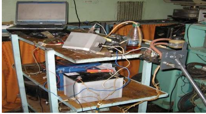
Рисунок 7 – Експериментальна установка для випробувань осциляційного модулятора тиску
