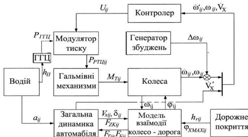
Рисунок 12 – Структурна схема процесу управління гальмуванням легкового автомобіля
