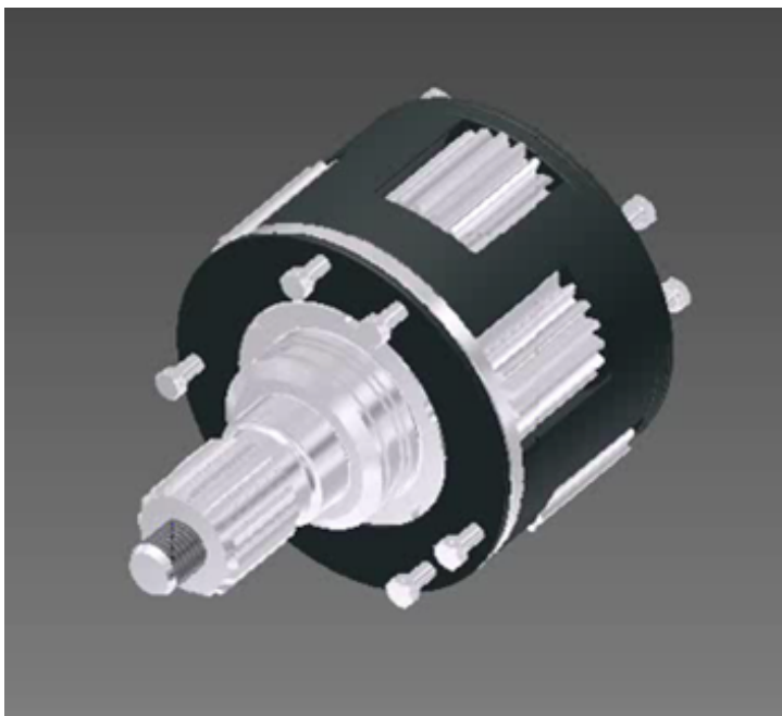
Рис 3 Планетарний механізм K2 із щепленими сателітами- загальний вигляд.
