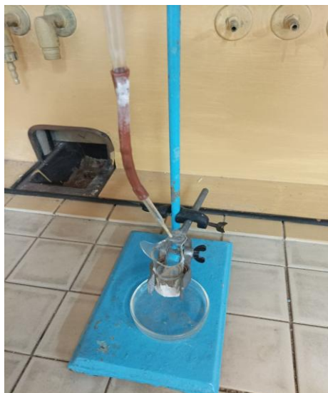
Рисунок 2.1 – Схема пристрою для дослідження трансмембранних властивостей біологічно активних полімерних гідрогелевих матеріалів
