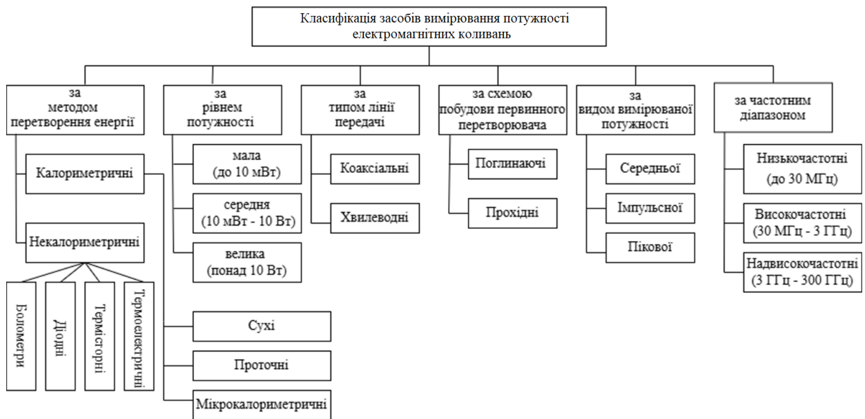
Рис. 1. Класифікація засобів вимірювання потужності електромагнітних коливань
