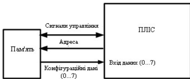
Рис. 4.54. Паралельне завантаження в режимі «ведучий» (перший спосіб)
