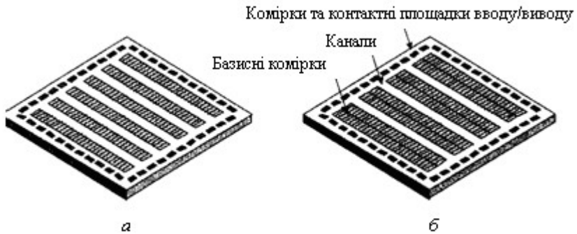
Рис. 4.24. Архітектура каналних логічних матриць: а – одностовпцеві масиви; б – двостовпцеві масиви
