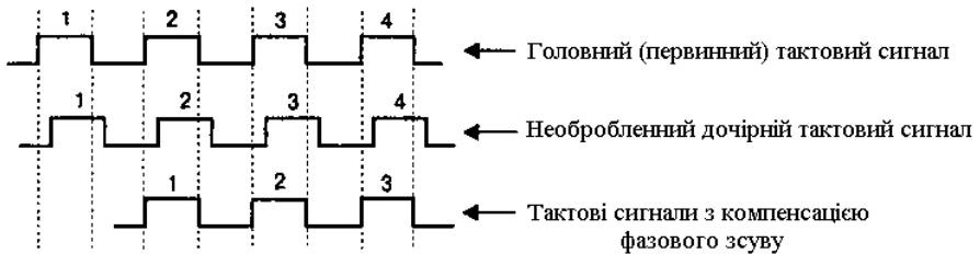
Рис. 4.49. Компенсація фазового зсуву відносно первинного тактового сигналу
