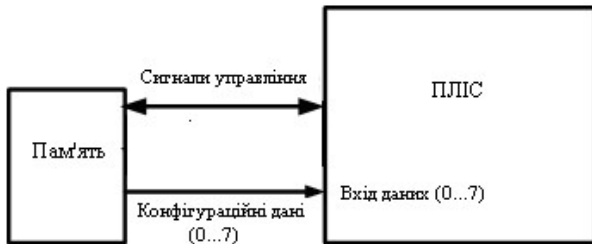
Рис. 4.55. Паралельне завантаження в режимі «ведучий» (сучасна реалізація)
