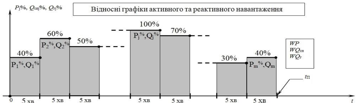
Рисунок 2 – Побудова відносного n -хвилинного графіку активної та реактивної потужності (при значенні n = 5 хвилин)
