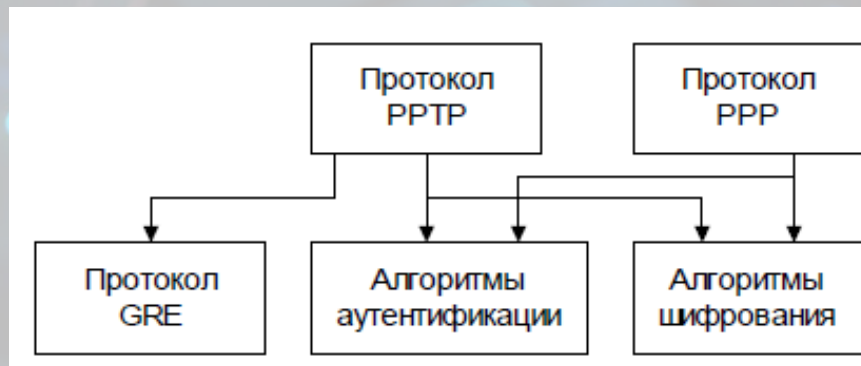
Архітектура протоколу PPTP
