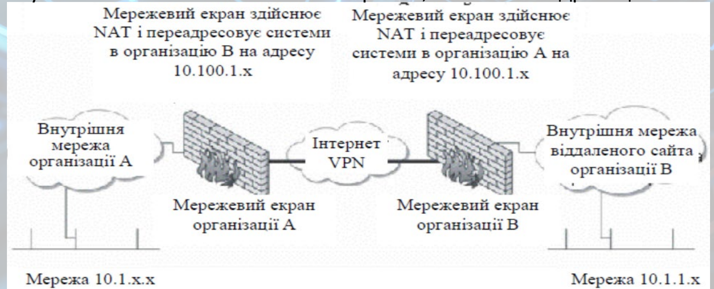
Вузлова VPN використовує NAT для запобігання конфліктам адресації
