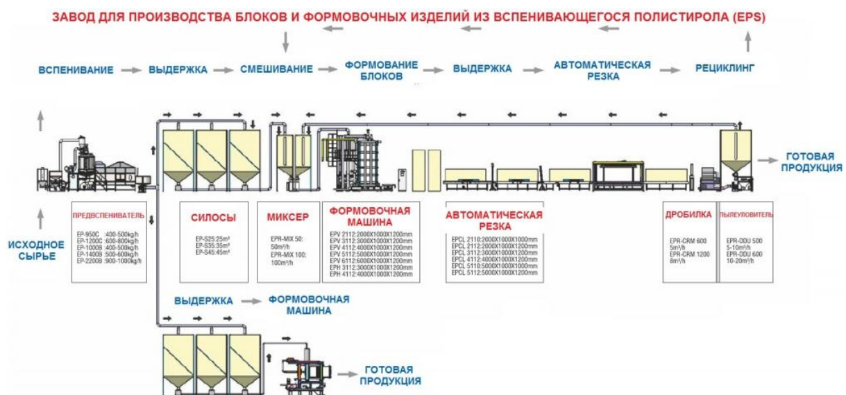
Рисунок 1 – Технологічна схема виготовлення виробів зі спіненого полістиролу
