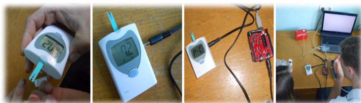
Рисунок 2 – Процесс сбора и передачи данных МТГ ЭС.
