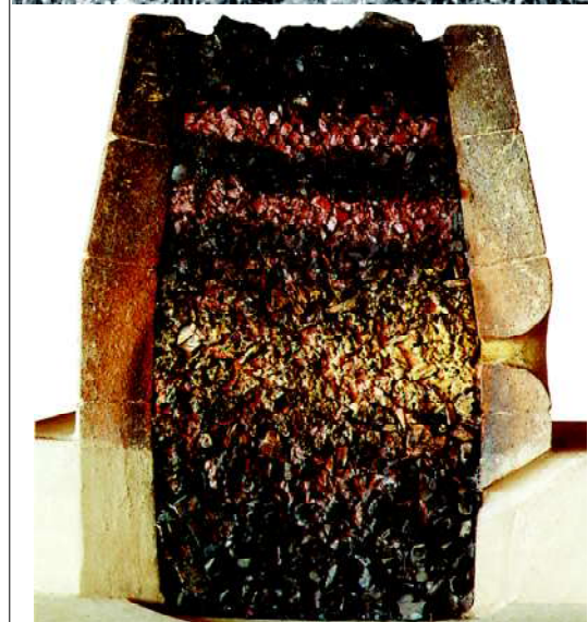
Рис. 3.9 - Реконструкція залізоплавильної печі конусного типу. Музей давньої металургії в Новій Слупі, Польща
