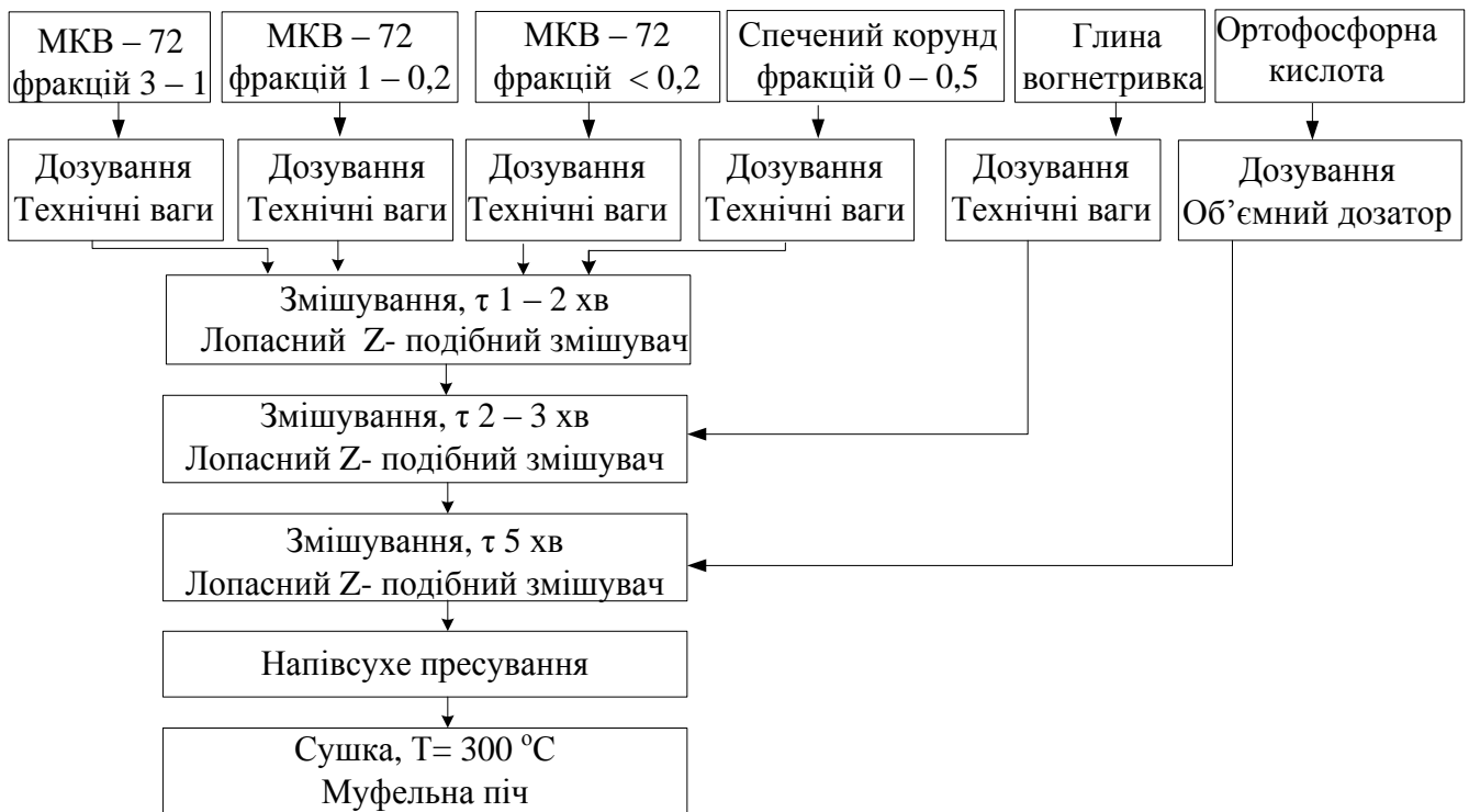
Рисунок 4 – Технологічна схема виробництва безвипального мулітокорундового вогнетривкого матеріалу
