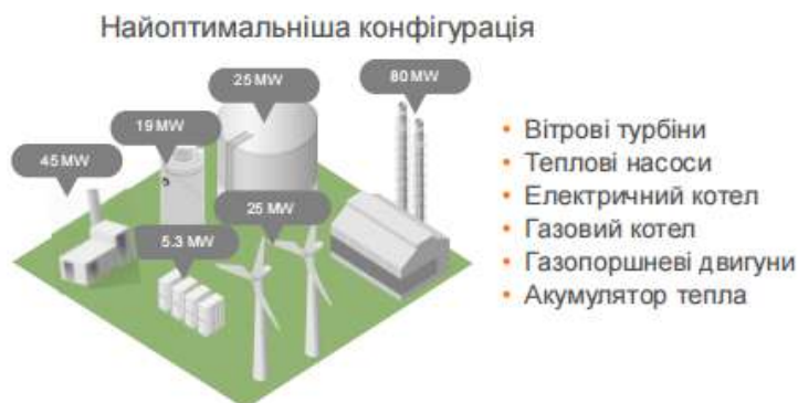
Рис. 1 – система централізованого теплопостачання в обласному центрі
