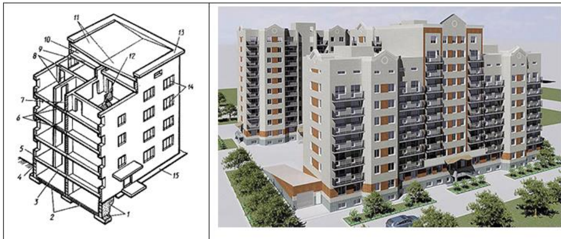
Рис. 2.10 Конструктивна схема безкаркасної багатоповерхової будівлі 1 - фундамент, 2 - підлога підвалу; 3 - перекриття над підвалом; 4 - гідроізоляція; 5 - зовнішні стіни; 6 - міжповерхові перекриття; 7 - внутрішні стіни; 8 - перегородки; 9 - горищенне перекриття; 10 - горище; 11 - дах; 12 - сходи; 13 - парпет; 14 - вікна; 15 - отмостка
