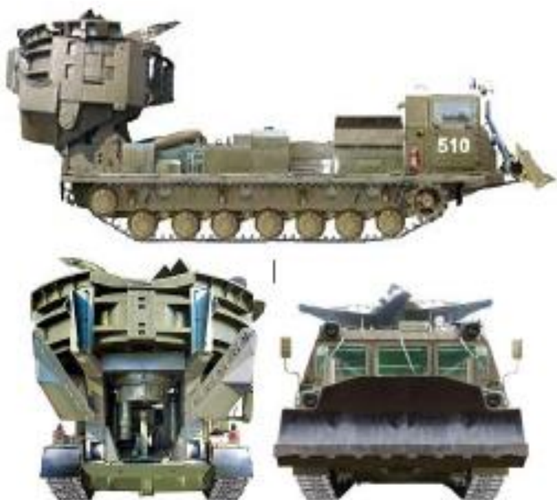
Рис. 3.14 Котлованна машина МДК-3
