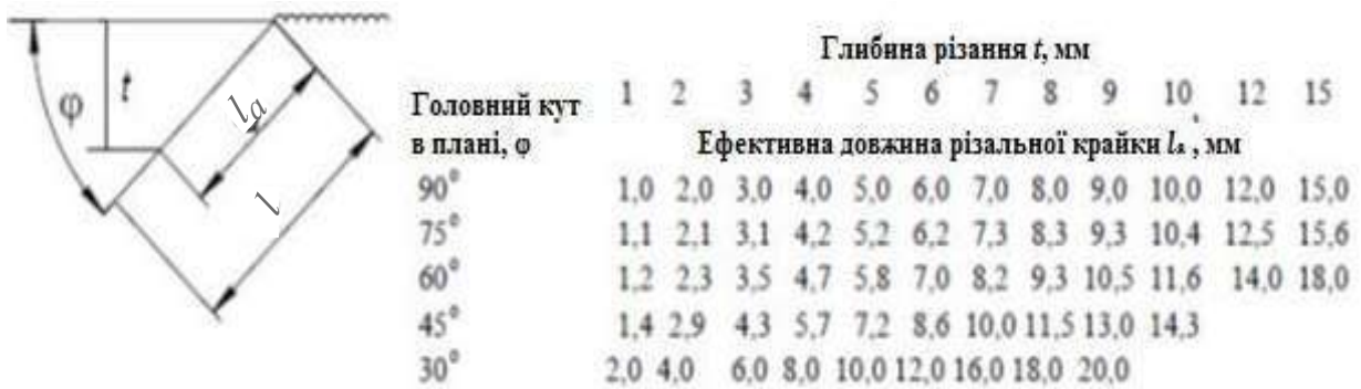
Рисунок 1.10 – Вибірвання ефективної довжини різальної крайки
