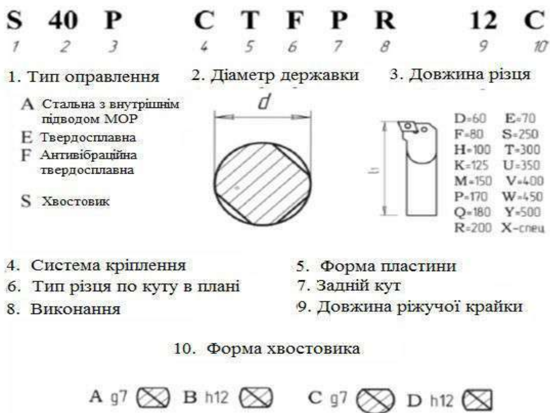
Рисунок 2.1 – Система позначення розточувальних різців
