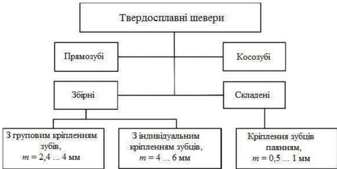
Рисунок 8.11 – Класифікація твердосплавних шеверів
